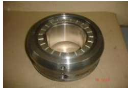
FF FAN BLOWER BEARING
